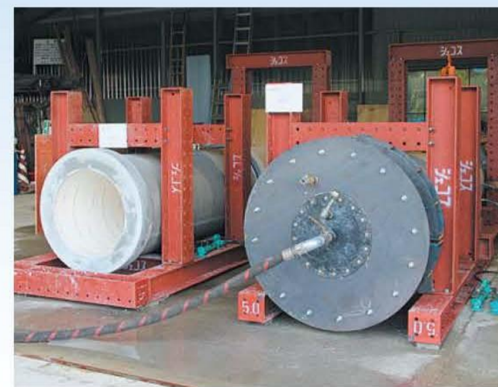
管軸方向の耐震性試験（レベル1）
